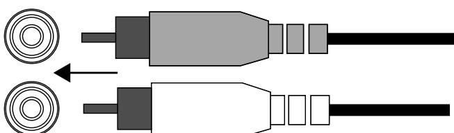
**Araba ses sistemi ana ünitesinin hat seviyesi çıkışı yoksa,** Stadium amplifikatörün girişlerini araba ses sistemi ana ünitesinin ön veya arka hoparlör çıkışlarından birine (uçları ekleme klipsi dâhil değildir) bağlamak için verilen çiplak telli RCA adaptörünü kullanın.
