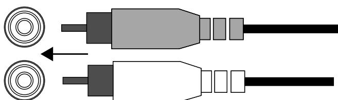
如果您的汽车音响系统主机没有线路电平输出,请使用随附的裸线至 RCA 适配器连接 Stadium 功放的输入端和您的汽车音响系统主机的前置或后置扬声器输出端(拼接器不随附)。
