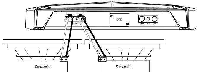
**Untuk memberi daya satu sub**, sambungkan kabel positif dari subwoofer tunggal ke terminal + di sebelah kiri, dan kabel negatif dari subwoofer ke terminal - di sebelah kanan.
