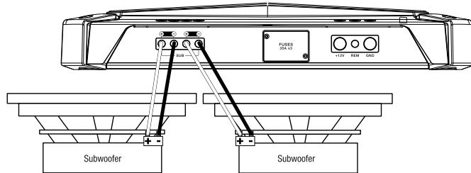
Tilslut den positive ledning fra den enkelte subwoofer til venstre + -terminal og den negative ledning fra subwooferen til højre L- terminal.
