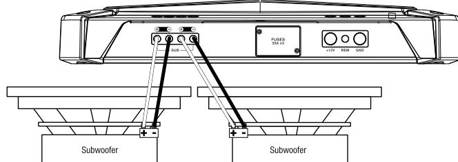
**Para usar um subwoofer,** conecte o fio positivo do subwoofer à saída esquerda + e o fio negativo à saída direita -.
