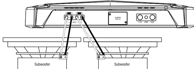
**Para alimentar un subwoofer**, conecta el cable positivo del subwoofer único al terminal izquierdo + y el cable negativo del subwoofer al terminal derecho -.
