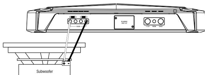
**OPMERKING:** Minimale luidsprekerimpedantie voor werking van de subwoofer is 2 ohm.
