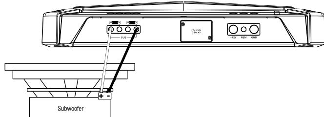
**NOT:** Subwoofer çalışması için minimum hoparlör empedansı 2ohm'dur.
