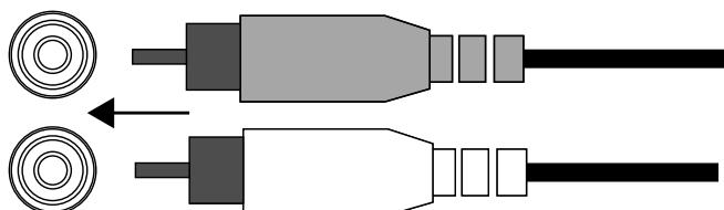
**Si la unidad central del sistema de audio del automóvil no tiene salidas de nivel de línea,** utiliza los adaptadores de cable pelado a RCA suministrados para conectar las entradas del amplificador Stadium a las salidas de altavoz delanteras o traseras de la unidad central de audio del vehículo (no se incluyen los conectores necesarios).
