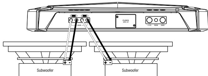
**1基のサブウーファーの電源を入れるには、シングル・サブウーファーから左+端子に陽電極ワイヤーを、右-端子に負電極ワイヤーを接続します。**
