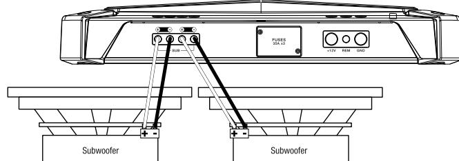
**Om du vill driva en subwoofer** kopplar du den positiva kabeln från subwofern till den vänstra plusterminalen, och den negativa kabeln från subwofern till den högre minusterminalen.
