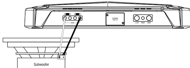
**NOTA:** La impedancia mínima del altavoz para el funcionamiento con subwoofer es de 2 Ohm.
