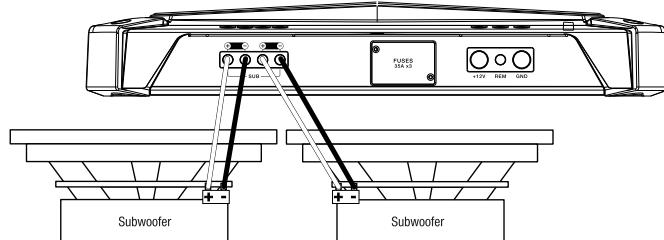
**若要為一個重低音喇叭供電**，請將單個重低音喇叭的正極電線連接至左 + 端子，並將重低音喇叭的負極電線連接至右 - 端子。
