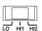
**注:** お持ちのアンプを工場出荷時のスピーカー出力に接続し、オーディオを再生できなかった場合は、スイッチを「ハイ2」に切り換えてください。「ハイ2」ポジションは、工場出荷時のオーディオシステムを調整し、スピーカーの出力端子に接続したことを確認するように設計された回路を内蔵しています。 **重要:** 「ハイ2」は、アンプがヘッドユニットのラインレベル(RCAタイプ)出力に接続されている場合は絶対に使用しないでください。
