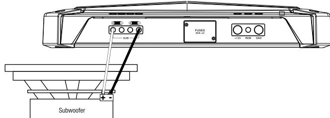
**NOTA:** L'impedenza minima di un altoparlante per il funzionamento del subwoofer è di 2 ohm.
