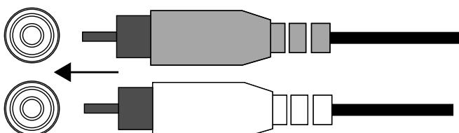
**Om ljudsystemets huvudenhet inte har utgångar med linjenivå** använder du de medföljande adaptrarna för avskalad kabel till RCA för att ansluta Stadium-förstärkarens ingångar till antingen de främre eller bakre högtalarutgångarna på bilens huvudenhet (krympskav medföljer ej).
