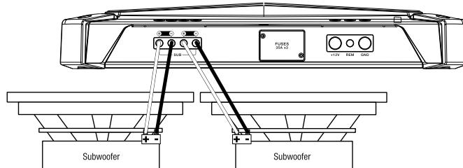
**Pour alimenter un subwoofer,** connectez le fil positif du subwoofer unique à la borne gauche + et le fil négatif du subwoofer à la borne droite -.
