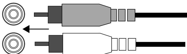
**如果汽車音響系統的主機沒有線路電平輸出**,請使用隨附的裸線至 RCA 配接器將 Stadium 放大器的輸入連接至汽車音響系統主機的前或後喇叭輸出(未隨附壓接工具)。
