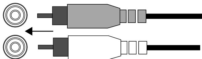
**Se o receiver do veículo não possuir saídas de nível de linha,** conecte as entradas do amplificador Stadium às saídas dos alto-falantes traseiros ou dianteiros usando os adaptadores de fio nu para RCA. (Os crimpes para emenda não vêm incluídos.)
