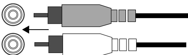
**Se la sorgente del sistema car audio non dispone di uscite livello linea**, utilizzare gli adattatori cavo spelato-RCA in dotazione per collegare gli ingressi dell'amplificatore Stadium alle uscite degli altoparlanti anteriori e posteriori dell'autoradio (crimpature a sezione quadrata non incluse).
