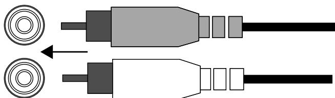
**Als de autoradio geen lijnniveau-uitgangen heeft,** gebruik dan de meegeleverde draad-naar-RCA-adapters om de ingangen van de Stadium-versterker aan te sluiten op de voorste of achterste luidsprekeruitgangen van het hoofdtoestel van de autoradio (splice crips niet inbegrepen).
