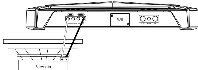
**OBS:** Lägsta högtalarimpedans för subwoofer-drift är 2 ohm.
