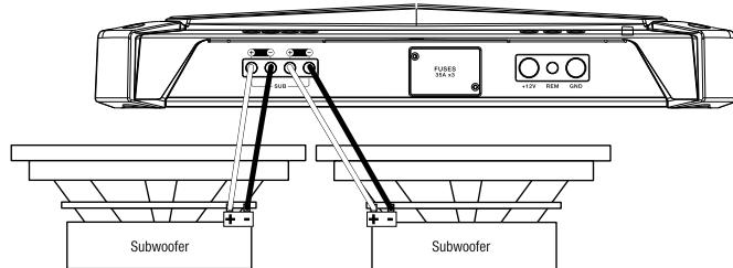
**Sluit om één sub aan te drijven** de positieve draad van de subwoofer naar de linker + aansluiting en de negatieve draad van de subwoofer naar de rechter - aansluiting.
