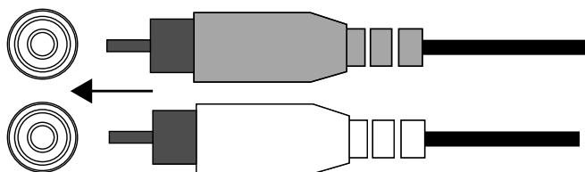
**Si l'unité principale de votre système audio automobile n'a pas de sorties de niveau ligne,** utilisez les adaptateurs de fil dénudé vers RCA fournis pour connecter les entrées de l'amplificateur Stadium aux sorties de haut-parleurs avant ou arrière de l'appareil principal de votre système audio automobile (cosses pour fils dénudés non incluses).
