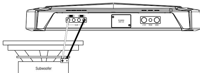
**BEMÆRK:** Minimum højttalerimpedans for subwoofer drift er 2 ohm.
