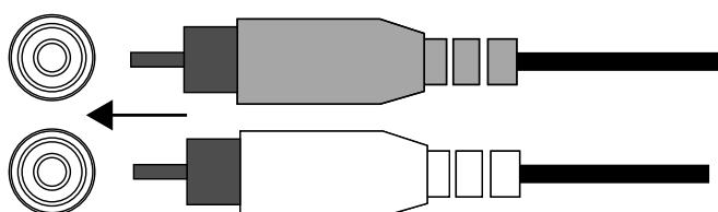
**Jika unit utama sistem audio mobil Anda tidak memiliki output tingkat lintasan,** gunakan kabel telanjang yang tersedia ke adaptor RCA untuk menyambungkan input amplifier Stadium baik ke output speaker depan atau belakang pada unit utama sistem audio mobil Anda (tidak termasuk sambungan kerutan).
