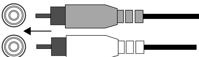
**Hvis hovedenheden i bilens lydsystem ikke har linjeniveauudgange,** skal du bruge de medfølgende ledning-til-RCA-adapttere til at forbinde Stadium-forstærkerens indgange til for- eller baghøjttalerudgangene på lydsystemets hovedenhed (splejseklemme er ikke inkluderet).
