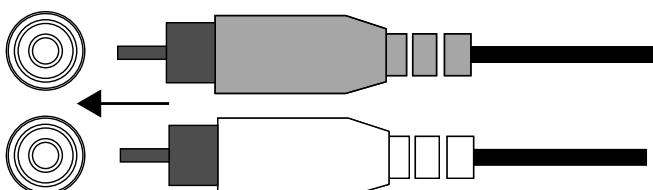
**Falls die Haupteinheit deiner Kfz-Audioanlage keine Line-Pegel-Ausgänge besitzt,** die mitgelieferten Blankdraht-zu-RCA-Adapter verwenden, um die Stadium Verstärkereingänge entweder an die Front- oder Hecklautsprecherausgänge der Kfz-Stereoanlage anzuschließen (Spleißcrimpanschlüsse nicht mitgeliefert).
