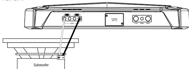
**CATATAN:** Impedansi speaker minimum untuk pengoperasian subwoofer adalah 2 ohm.
